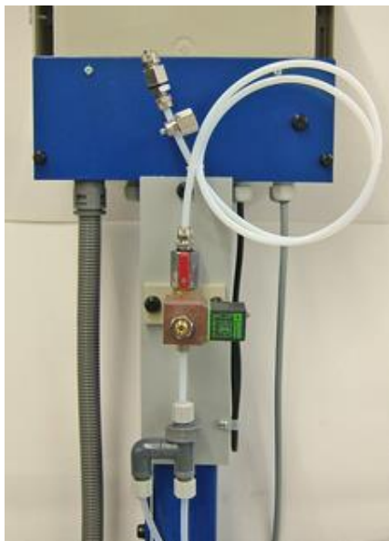
Abb. 1: Steuerventil mit Anschlusschläuchen PTFE (da das Steuerventil im Betrieb heiß wird)
