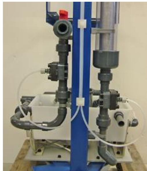
Abb. 2: Praher Pneumatikventile in der Zuleitung (von hinten rechts) und der Dosierleitung (links)
